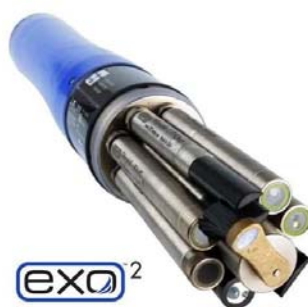
Figure 253 : Illustration d'une sonde de mesures multiparamètre équipée d'un capteur de turbidité
